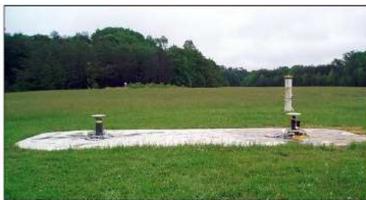
图3.1 接收机天线野外校检场
