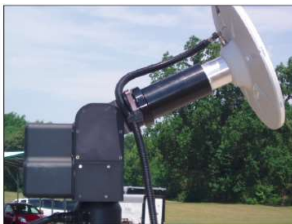
图3.2 接收机天线校验机器人手臂
