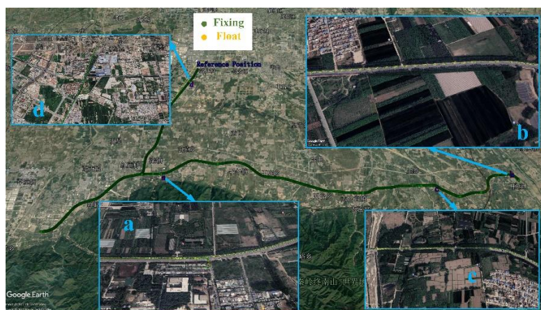
图 5.6 实测动态数据采集轨迹，其中绿色为固定解，黄色为浮点解。a、b、c、d 为定位干扰较为严重区域
