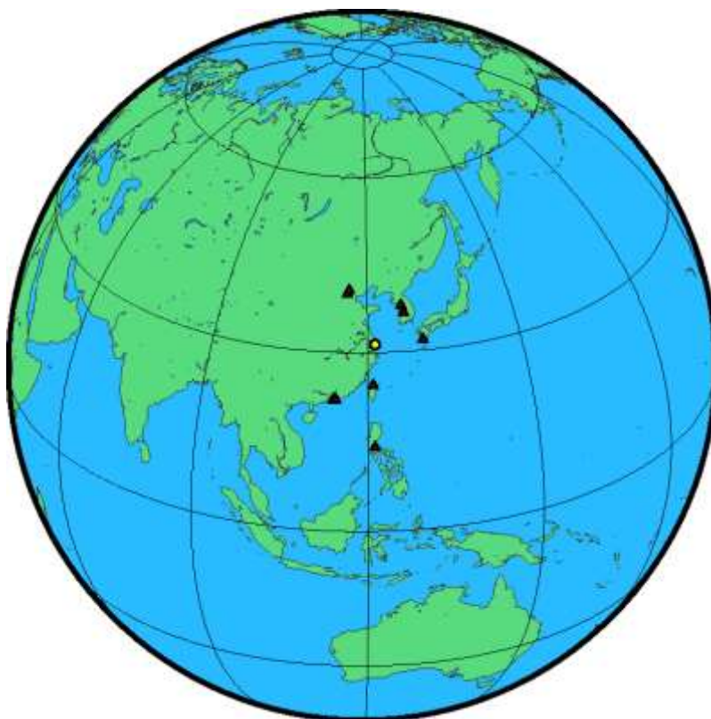
图 4.1 AUSPOS 网解测站分布图（图中黄色圆圈为 TJCH 测站，三角点位参考站）
